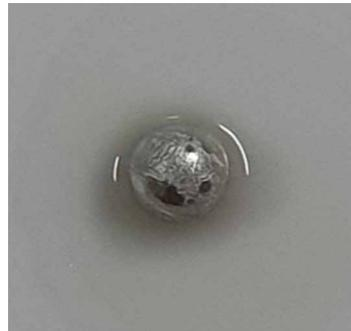
Die Rückstände des Flussmittels der SP6000 sind nach dem Lötten klar und transparent – dies verhindert die Detektion von Pseudofehlern bei der automatischen optischen Inspektion (AOI).
